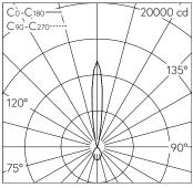
LED 3000 K 39 W 3064 lm-h / CIE Flux 86 99 100 69 100 / B84 nach DIN 5040
