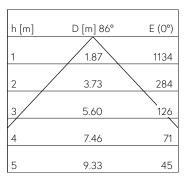
LED 3000 K 18.8 W 2205 lm-h 86° / CIE Flux 73 96 100 100 / A60 nach DIN 5040
