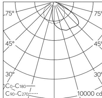
LED 4000 K 51 W 6331 lm-h / CIE Flux 47 83 97 100 100 / A40 nach DIN 5040
