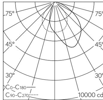
LED 4000 K 56 W 6127 lm-h / CIE Flux 63 92 99 100 100 / A60 nach DIN 5040
