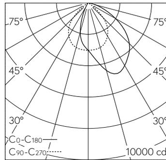
LED 3000 K 56 W 5974 lm-h / CIE Flux 63 92 99 100 100 / A60 nach DIN 5040
