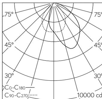
LED 4000 K 56 W 6035 lm-h / CIE Flux 63 91 99 100 100 / A50 nach DIN 5040
