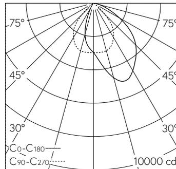
LED 3000 K 56 W 5653 lm-h / CIE Flux 67 93 100 100 100 / A60 nach DIN 5040
