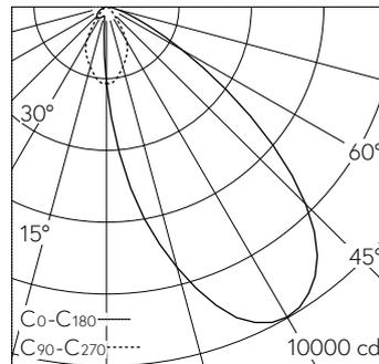
LED 4000 K 60 W 6674 lm-h / CIE Flux 66 95 99 100 100 / A60 nach DIN 5040
