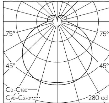
LED 3000 K 8.8 W 906 lm-h / CIE Flux 40 70 89 79 100 / B32 nach DIN 5040
