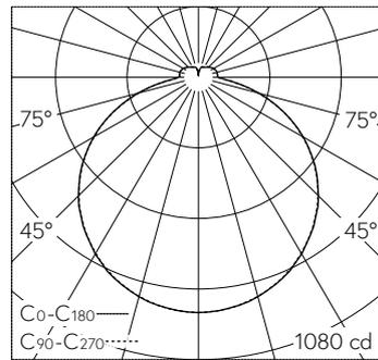
LED 4000 K 25.6 W 3293 lm-h / CIE Flux 43 74 92 88 100 / B31 nach DIN 5040
