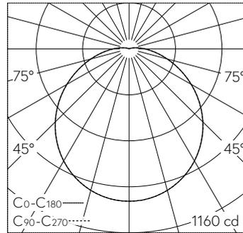
LED 3000 K 27 W 3083 lm-h / CIE Flux 44 74 91 97 100 / A30 nach DIN 5040
