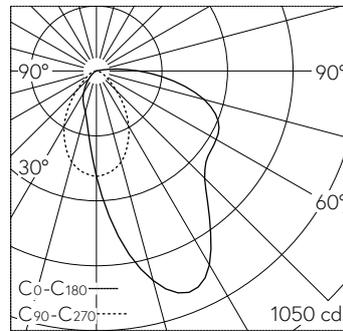
LED 3000 K 10 W 1189 lm-h / CIE Flux 44 71 90 99 100 / A30 nach DIN 5040
