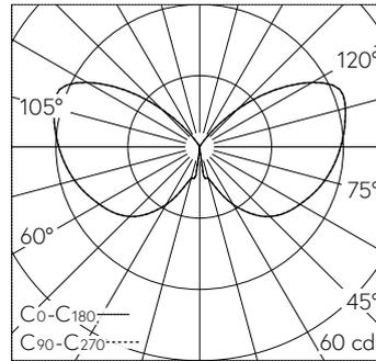
LED 3000 K 5 W 356 lm-h / CIE Flux 14 39 67 52 100 / C11 nach DIN 5040
