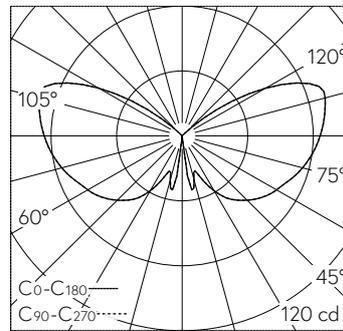
LED 3000 K 14.3 W 695 lm-h / CIE Flux 15 39 67 56 100 / C11 nach DIN 5040
