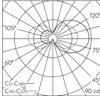
LED 3000 K 3.8 W 383 lm-h / CIE Flux 10 33 63 45 100 / C11 nach DIN 5040
