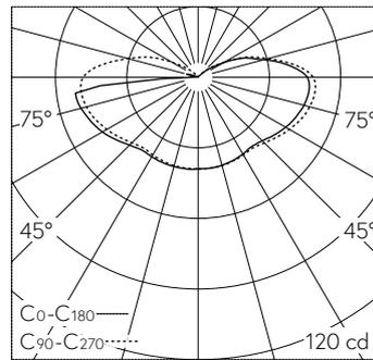
LED 3000 K 5 W 376 lm-h / CIE Flux 22 46 71 73 100 / B11 nach DIN 5040
