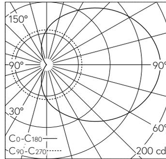
LED 3000 K 9.2 W 830 lm-h / CIE Flux 22 46 72 50 100 / C12 nach DIN 5040
