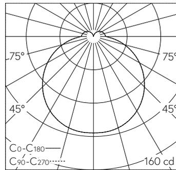
LED 3000 K 4.8 W 439 lm-h 126°/126° / CIE Flux 40 70 89 85 100 / B31 nach DIN 5...
