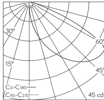
LED 4000 K 6.8 W 49 lm-h / CIE Flux 29 71 97 100 100 / A20 nach DIN 5040
