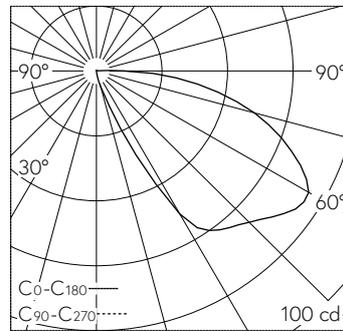
LED 3000 K 8.8 W 111 lm-h / CIE Flux 16 51 83 99 100 / A10 nach DIN 5040
