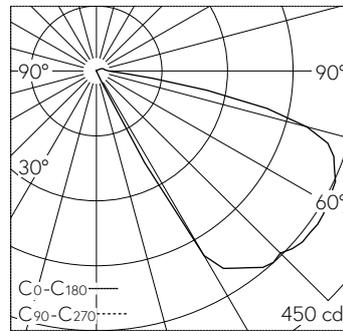
LED 3000 K 9 W 563 lm-h / CIE Flux 13 49 84 98 100 / A11 nach DIN 5040
