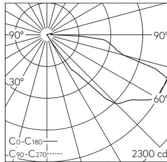
LED 3000 K 22.6 W 2208 lm-h / CIE Flux 4 36 77 98 100 / A10 nach DIN 5040
