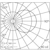
LED 4000 K 3.9 W 143 lm-h / CIE Flux 13 37 66 50 100 / C11 nach DIN 5040
