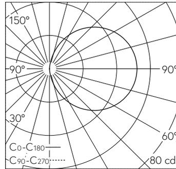
LED 3000 K 2.7 W 182 lm-h / CIE Flux 13 37 66 50 100 / C11 nach DIN 5040
