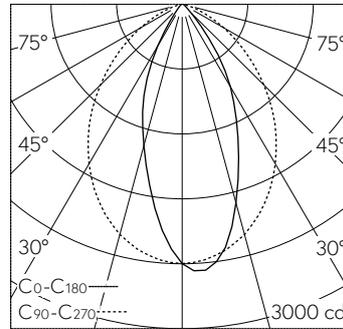
LED 4000 K 19 W 2006 lm-h / CIE Flux 78 96 100 100 100 / A70 nach DIN 5040
