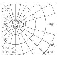
LED 3000 K 0.6 W 2 lm-h / CIE Flux 11 34 63 50 100 / C11 nach DIN 5040
