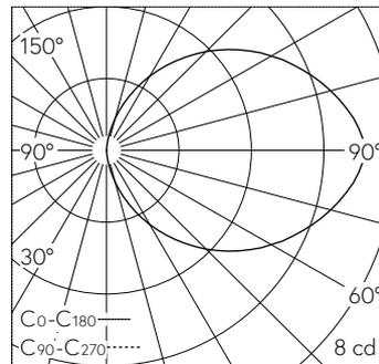
LED 3000 K 0.7 W 18 lm-h / CIE Flux 11 34 63 50 100 / C11 nach DIN 5040
