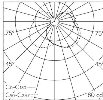
LED 3000 K 3.9 W 288 lm-h / CIE Flux 29 56 79 65 100 / B21 nach DIN 5040
