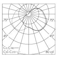
LED 4000 K 3.9 W 309 lm-h / CIE Flux 26 53 77 67 100 / B21 nach DIN 5040
