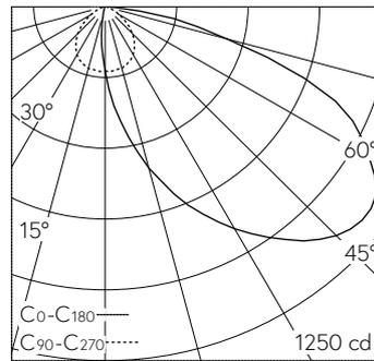
LED 3000 K 19 W 2321 lm-h / CIE Flux 31 68 94 100 100 / A20 nach DIN 5040
