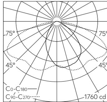
LED 3000 K 30.4 W 3411 lm-h / CIE Flux 42 76 95 100 100 / A30 nach DIN 5040
