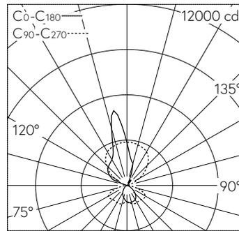
LED 4000 K 67 W 8847 lm-h / CIE Flux 42 76 95 43 100 / C34 nach DIN 5040
