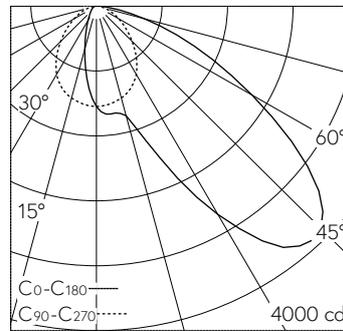
LED 4000 K 35.6 W 4714 lm-h / CIE Flux 39 79 96 100 100 / A30 nach DIN 5040
