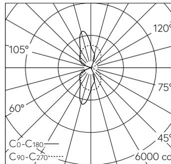
LED 4000 K 38 W 5372 lm-h / CIE Flux 59 88 100 50 100 / C54 nach DIN 5040
