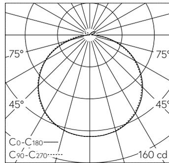
LED 3000 K 10 W 514 lm-h / CIE Flux 44 75 93 95 100 / A41 nach DIN 5040
