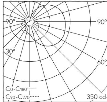
LED 4000 K 5.8 W 549 lm-h / CIE Flux 25 51 76 63 100 / B11 nach DIN 5040
