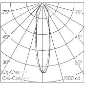
LED 3000 K 5.3 W 307 lm-h / CIE Flux 99 100 100 100 100 / A80 nach DIN 5040
