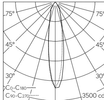
LED 3000 K 10.3 W 743 lm-h / CIE Flux 98 100 100 100 100 / A80 nach DIN 5040
