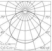
LED 3000 K 15.6 W 1708 lm-h 116° / CIE Flux 45 75 93 94 100 / A41 nach DIN 5040
