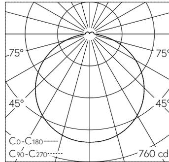
LED 3000 K 22 W 2445 lm-h 118° / CIE Flux 45 76 94 94 100 / A41 nach DIN 5040
