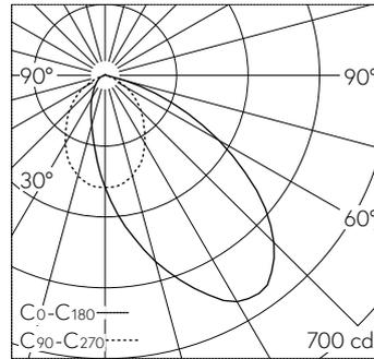
LED 4000 K 9.5 W 663 lm-h / CIE Flux 51 86 99 100 100 / A40 nach DIN 5040
