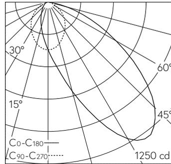
LED 4000 K 16.5 W 1426 lm-h / CIE Flux 48 84 98 100 100 / A40 nach DIN 5040
