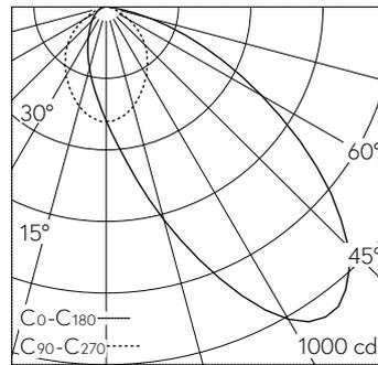
LED 3000 K 16.5 W 1389 lm-h / CIE Flux 48 85 98 100 100 / A40 nach DIN 5040
