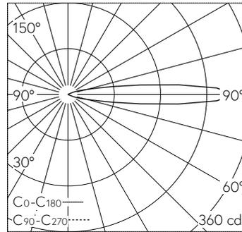
LED 3000 K 0.5 W 32 lm-h / CIE Flux 0 2 12 50 100 / C11 nach DIN 5040
