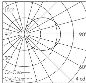
LED 4000 K 1.4 W 133 lm-h / CIE Flux 12 36 66 50 100 / C11 nach DIN 5040
