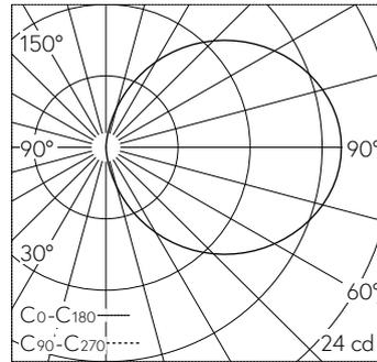
LED 3000 K 1.6 W 54 lm-h / CIE Flux 12 37 66 50 100 / C11 nach DIN 5040
