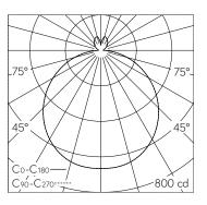
LED 3000 K 28.8 W 2263 lm-h / CIE Flux 46 76 94 89 100 / B43 nach DIN 5040
