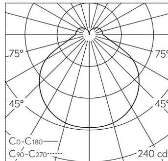
LED 3000 K 7.2 W 709 lm-h / CIE Flux 43 75 91 82 100 / B31 nach DIN 5040
