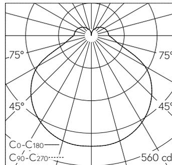
LED 3000 K 21 W 1970 lm-h / CIE Flux 42 74 91 82 100 / B31 nach DIN 5040
