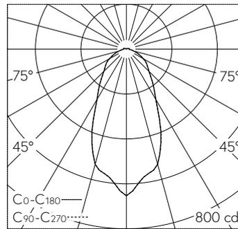
LED 3000 K 13.3 W 851 lm-h / CIE Flux 62 85 96 96 100 / A51 nach DIN 5040
